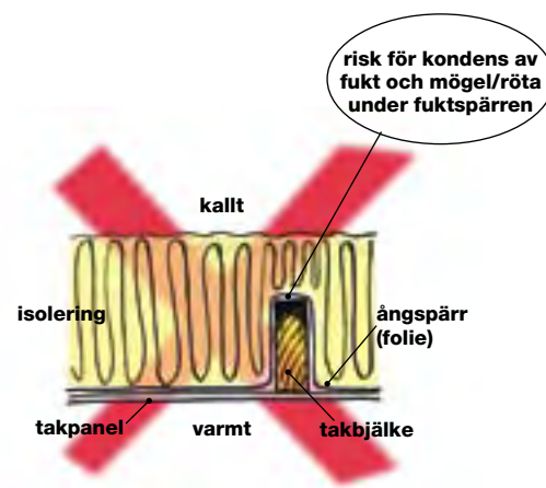
Felaktig placering av ångspärr vid tilläggsisolering av vindsbjälklag i äldre hus (utan tidigare ångspärr).
